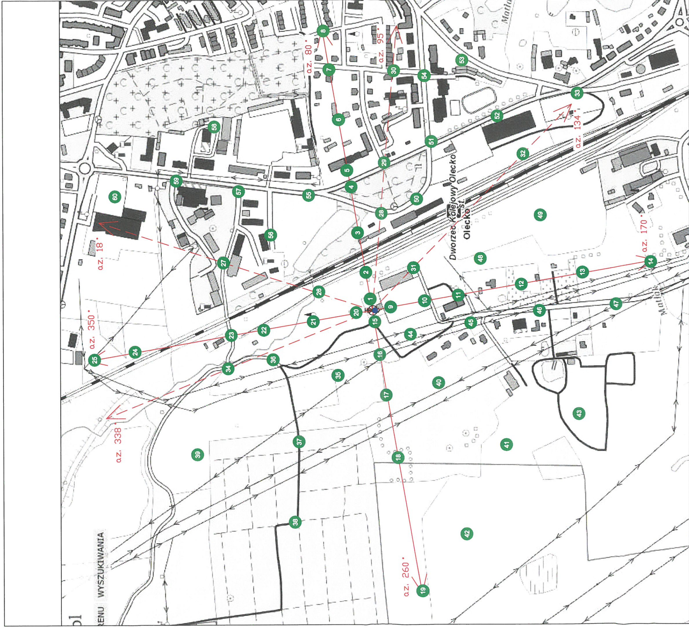
Rys.1 Lokalizacja pionów pomiarowych
